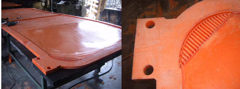
Fabricación de placa de filtración de una sola pieza.
