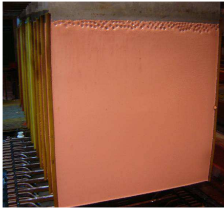
Cátodo en celda EW con sistema de aireación
