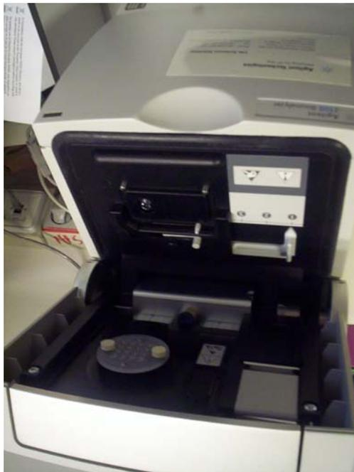
Figura 3. Bioanalizador utilizado en el Laboratorio de Ecología Molecular, utilizado para determinar la concentración y calidad del ARN.
