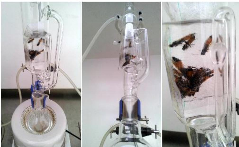
Figura 16: Extracción Soxhlet de insectos enteros
