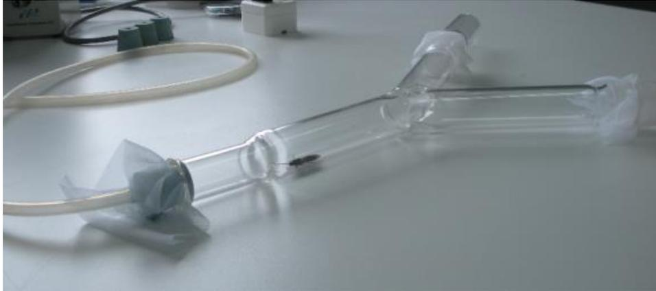
**Figura 20: Insecto en olfatómetro tubo Y**
