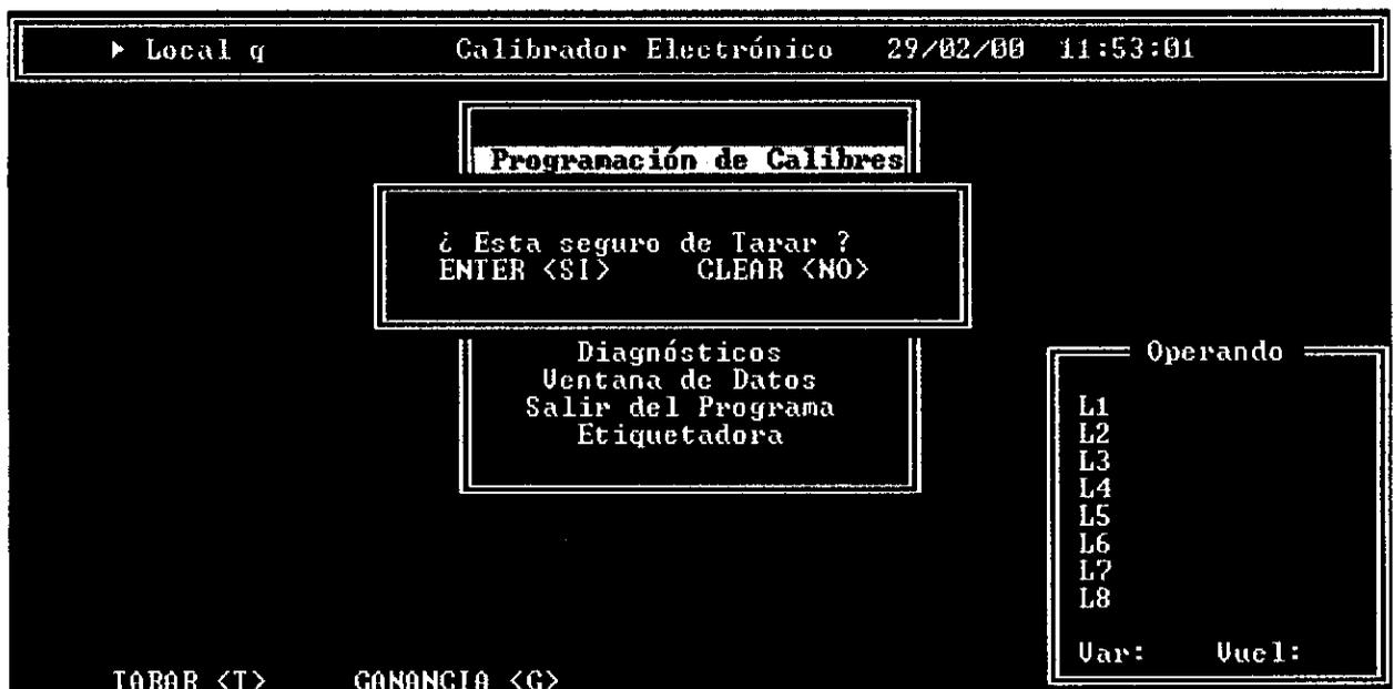
4.- Una vez que el sistema termine de tarar y salga en la pantalla operando, se debe colocar un peso patrón (130 a 200 grs) en cada capacho que se encuentra sobre la celda de carga. En la pantalla del computador de control aparecerá un valor en la línea en la cual se coloco el peso.
